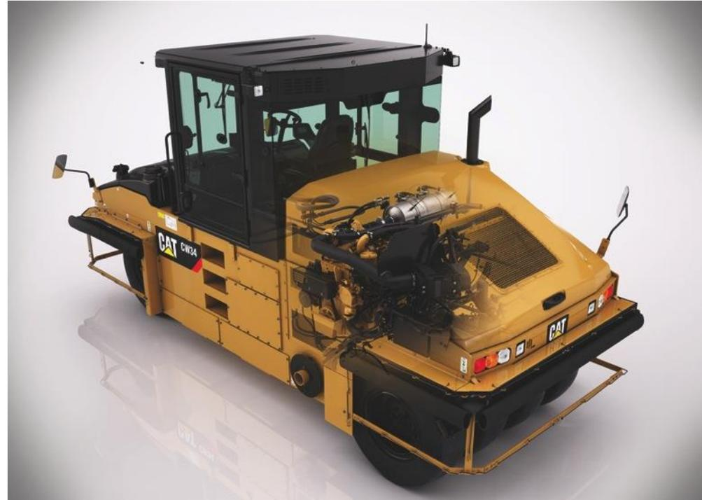
*O CW34 opera eficientemente em temperaturas de até 49° C com carga máxima do motor, devido ao sistema de arrefecimento de alto volume e ao grande ventilador.*
