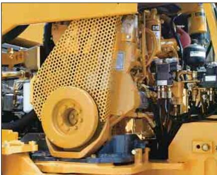
*As grandes portas de serviço do motor proporcionam óptimo acesso ao motor e aos componentes hidráulicos a partir do solo.*
