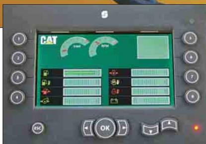
*O visor de grandes dimensões proporciona parâmetros de operação para diagnósticos da máquina e do motor. (Visor a cores opcional ilustrado.)*
