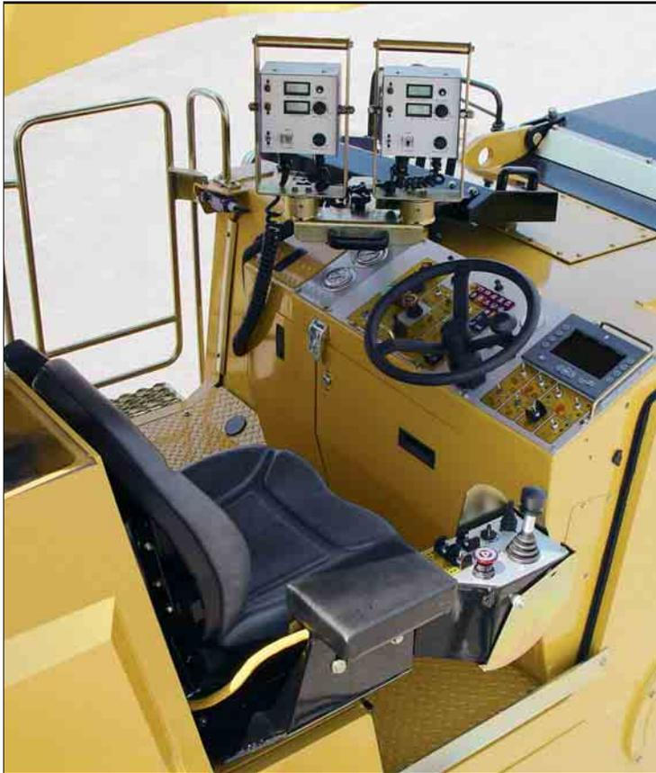
**Cabina de operação ergonómica.** A cabina de operação com largura integral proporciona uma visão sobre o transportador de carregamento dianteiro e as placas laterais para um posicionamento preciso e rápido.
