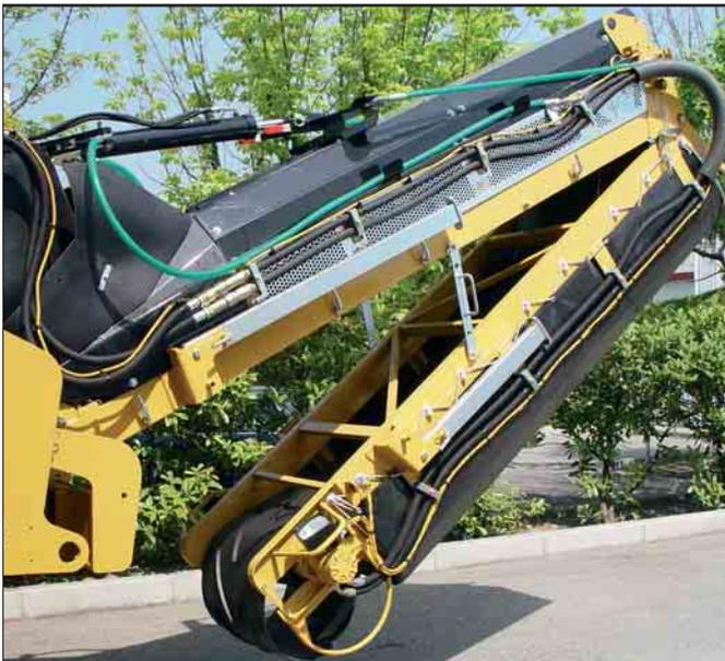
**Transportador dobrável.** O transporte da máquina é facilitado dobrando o transportador frontal o que reduz as dimensões da máquina.
