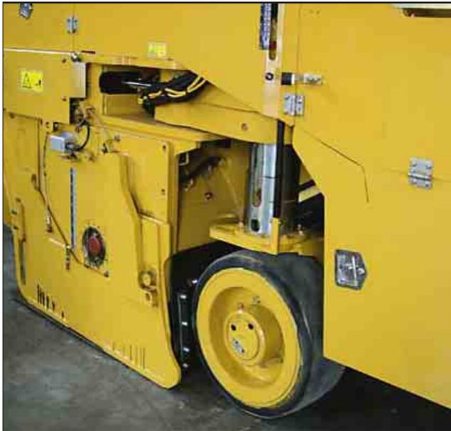
**Tracção total.** A transmissão hidrostática às quatro rodas, através de um eixo dianteiro divisor de caudal e autoequilibrador, garante uma tracção positiva e um óptimo desempenho em todas as aplicações.
