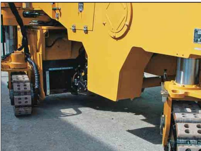
**Comando preciso.** Um microprocessador controla electronicamente o ângulo da direcção do rasto direito traseiro. O ângulo de direcção do rasto traseiro é automaticamente ajustado em relação à posição dos rastos dianteiros.
