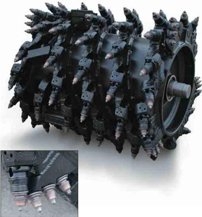
**Acessórios com 97 luvas de carbeto de tungstênio.** Os acessórios são montados em três porta-acessórios duráveis, de engate rápido e dispostos num arranjo de asa tripla para máxima força de rompimento.
