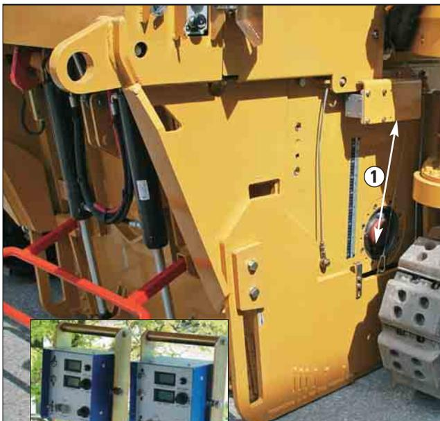
**Sensores de contacto de rampa de arame (io-io).** Os sensores de inclinação de arame medem o movimento das placas laterais que permite que todo o comprimento da placa lateral se torne um dispositivo de nivelamento para uma equiparação precisa da inclinação. Sensores de inclinação cruzada agregam à versatilidade do sistema.
