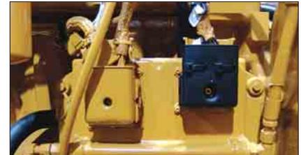
**O módulo de comando electrónico ADEM™ A4.** Este módulo gere a distribuição do combustível, a regulação da abertura das válvulas e o caudal de ar para um desempenho eficiente por cada litro de combustível utilizado. O módulo de comando proporciona um mapeamento flexível do combustível, permitindo que o motor responda rapidamente às necessidades variáveis da aplicação. Monitoriza as condições do motor e da máquina ao mesmo tempo que mantém o motor em operação na máxima eficiência.
