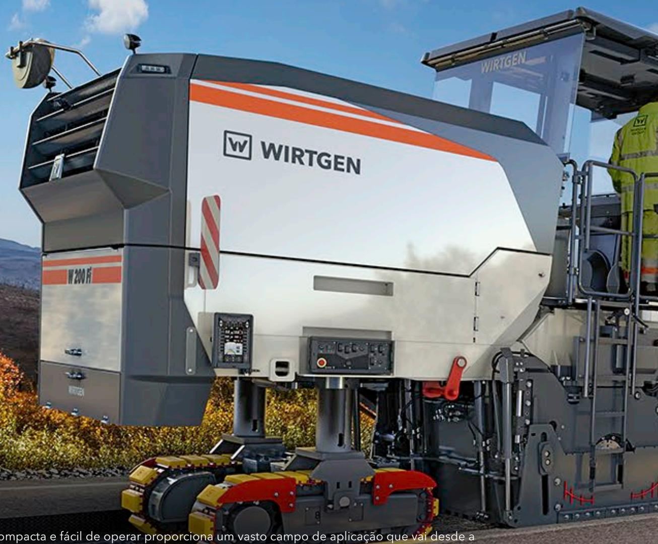
A fresadora a frio compacta e fácil de operar proporciona um vasto campo de aplicação que vai desde a recuperação de camadas de revestimento até aos trabalhos de fresagem fina, passando pela remoção total do pavimento.
